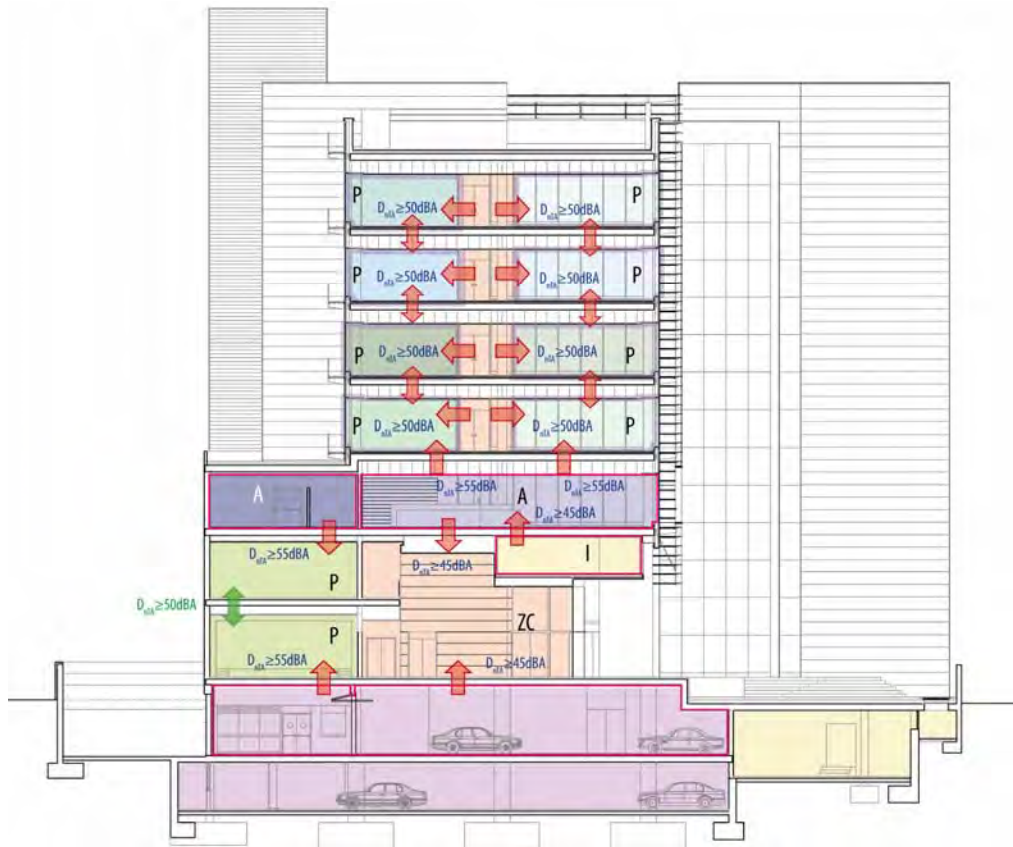
Figura A2.55. Sección del edificio y valores de aislamiento acústico a ruido aéreo exigidos
