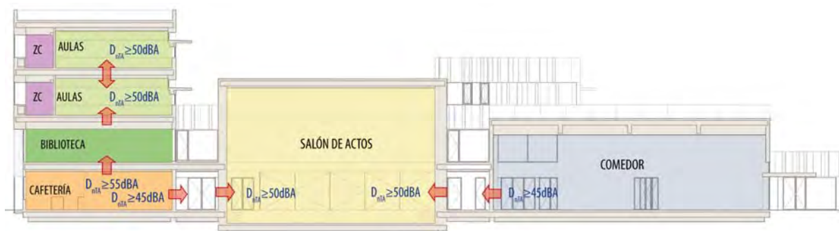
Figura A2.34. Sección por salón de actos indicando las exigencias aplicables a ruido aéreo
