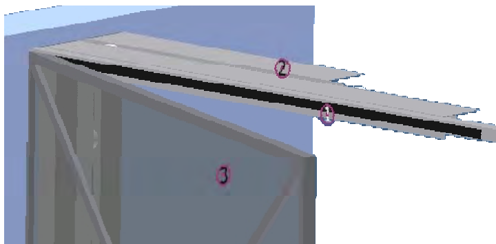
Figura PG-03 Ejemplo de colocación banda elástica sobre el cerco de la puerta
